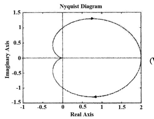
۹۵- دیاگرام قطبی تابع تبدیل حلقه یک سیستم فیدبک واحد در شکل نشان داده شده است. کدام گزینه در مورد پایداری سیستم حلقه بسته درست است؟ (دقت کنید که دیاگرام قطبی تماماً موهومی است).
