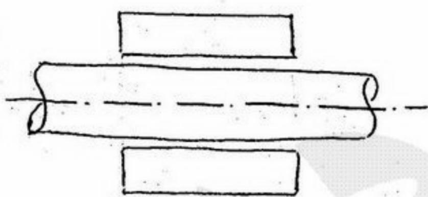
۱۰۳- استوانه‌ای به شعاع ۲ m و ارتفاع ۱۰m (عمود بر صفحه کاغذ) مطابق شکل در مجاورت آب قرار گرفته است. نیروی افقی وارد بر استوانه چقدر است؟
