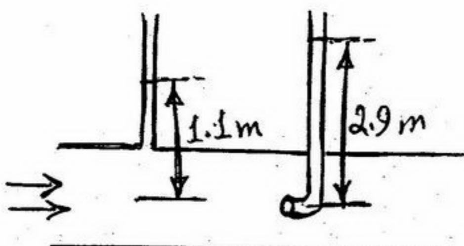
۱۰۶- در طرفین مخزن نشان داده شده، دریچه‌های یکسانی وجود دارد. از دریچه ۱ آب به صورت جت آزاد و از دریچه ۲ آب بر روی یک بستر افقی تخلیه می‌شود. کدام یک از عبارات زیر در مورد دبی‌ها صحیح است؟
