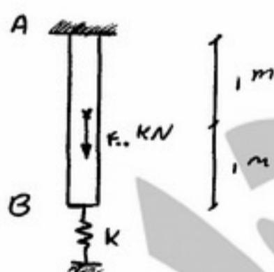
$$4 \times 10^{-2} \text{ m}^2 = \text{سطح مقطع میله و } 200 \text{ GPa} = \text{ضریب الاستیسیته میله}$$
