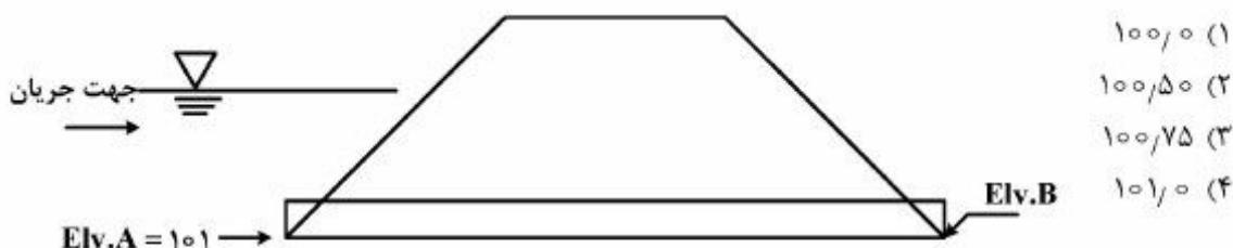
۱۹۵- در تبدیل مطابق شکل زیر، اگر ارتفاع آزاد در دیواره فوقانی لوله  $40$  سانتی‌متر، قطر لوله  $1/5$  متر، زاویه نصب لوله  $60$  درجه و اختلاف ارتفاع معادل بار جنبشی ( $\Delta h_v$ ) برابر  $4$  سانتی‌متر باشد، مقدار a چقدر است؟
