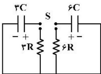
$$i_3(t) = \frac{V_o}{6R} e^{-\frac{t}{RC}}, \quad i_6(t) = \frac{V_o}{3R} e^{-\frac{t}{RC}} \quad (1)$$
