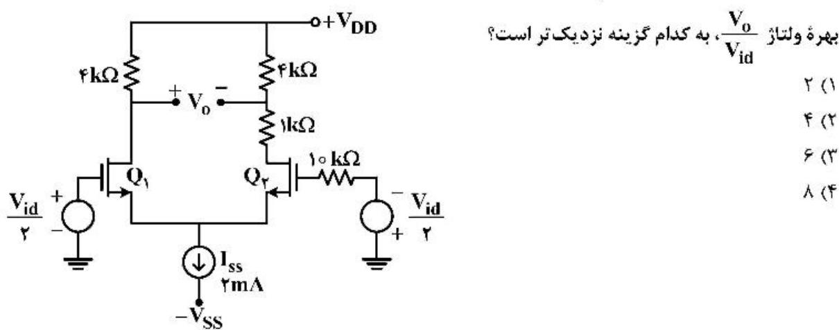
۱۲۴ - در تقویت‌گننده زیر، با فرض این‌که کلیه ترانزیستورها دارای  $r_o = ۵0 k\Omega$ ،  $r_{\pi} = ۵0 k\Omega$ ،  $\beta = ۱۰۰$  و  $V_{BE} = ۰.۷V$  باشند، ضروب CMRR به کدام گزینه نزدیک‌تر است؟
